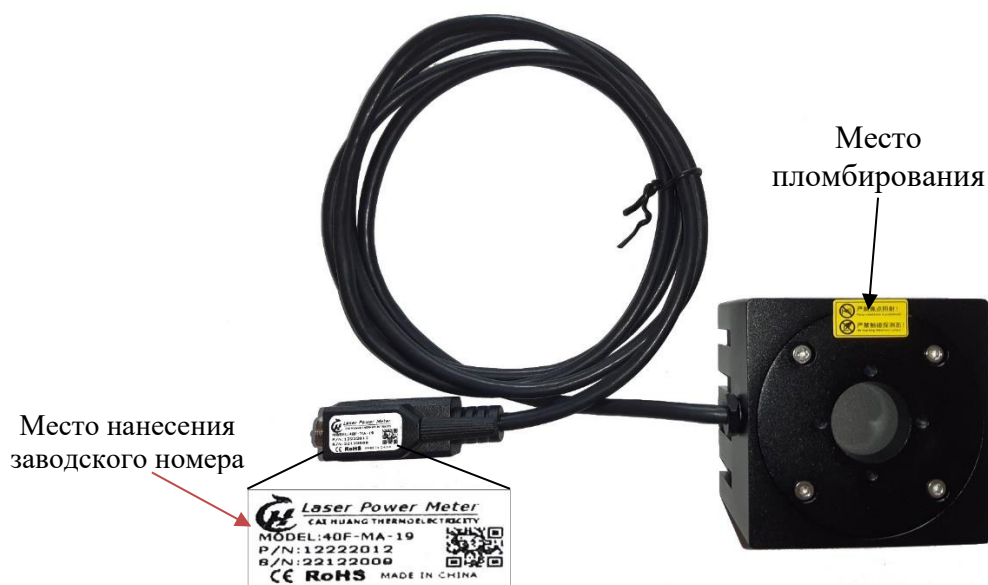
Рисунок 2 – Схема пломбировки от несанкционированного доступа, обозначения мест нанесения маркировок
