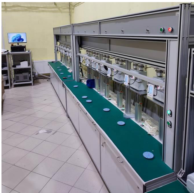
Рисунок 1 – Общий вид установки поверочной счетчиков газа GNP-12
