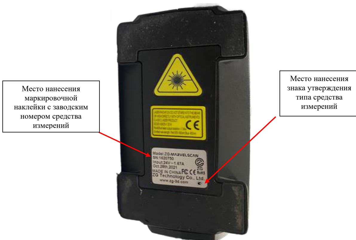
Рисунок 3 - Место расположения маркировочной наклейки с указанием заводского номера средства измерений.
