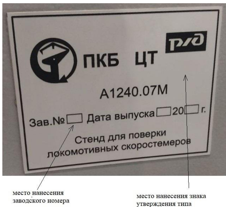
Рисунок 2 – Маркировочная табличка стенда для поверки локомотивных скоростемеров А1240.07М
