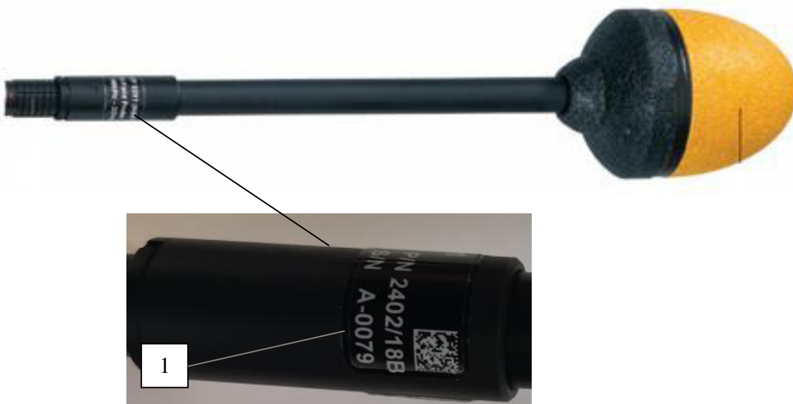
Рисунок 3 – Общий вид антенны-преобразователя Probe EF9091 с местом нанесения заводского номера
