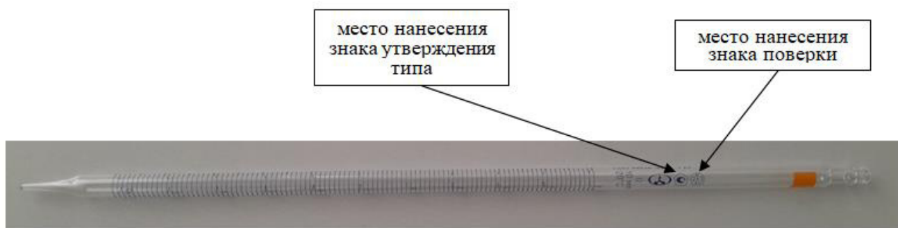
Рисунок 3 – Общий вид пипетки градуированной 1-го класса точности типа 1 с указанием мест нанесения знака утверждения типа и знака поверки
