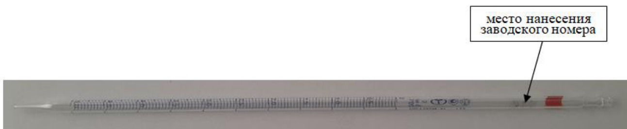
Рисунок 4 – Общий вид пипетки градуированной 1-го класса точности типа 1 с указанием места нанесения заводского номера
