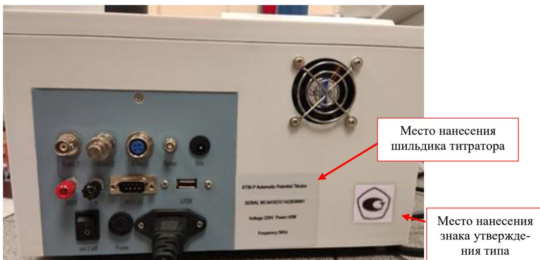
Рисунок 6 – Общий вид титратора модификации AT50-P, вид сзади
