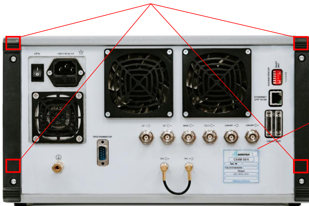
Рисунок 2 – Общий вид анализаторов с указанием мест нанесения пломбировки и заводского номера
