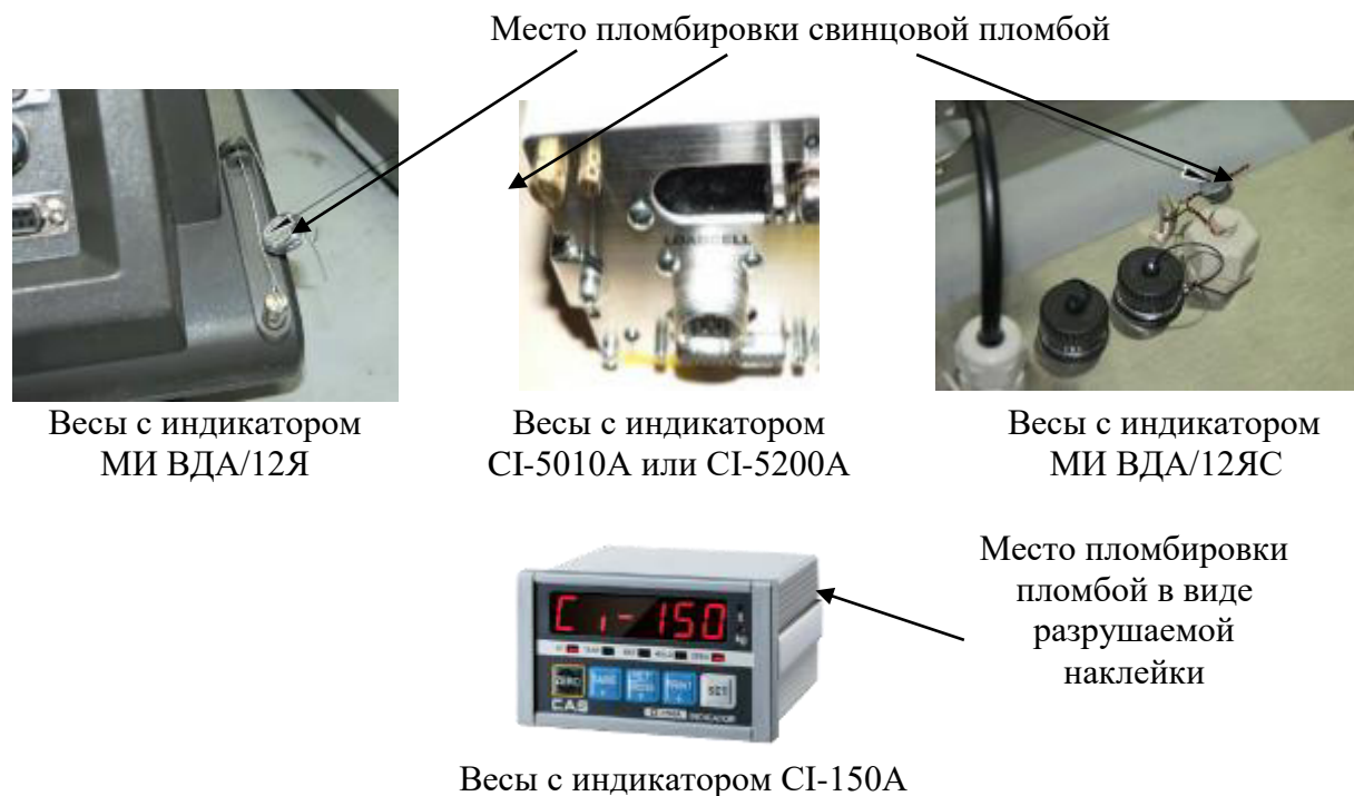
Рисунок 3 – Схема пломбировки от несанкционированного доступа, обозначение мест нанесения знака поверки
