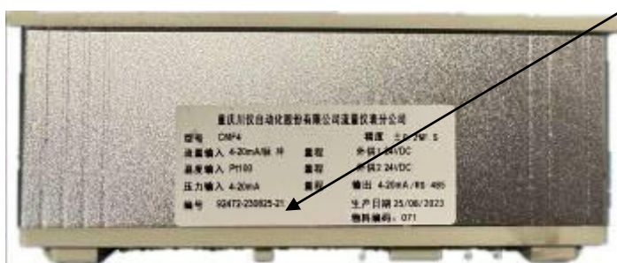
Рисунок 2 – Место нанесения серийного номера
