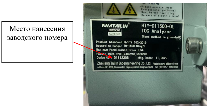
Рисунок 2 – Внешний вид боковой части корпуса анализатора общего органического углерода HTY-DI1500-OL с указанием места нанесения и формата заводского номера
