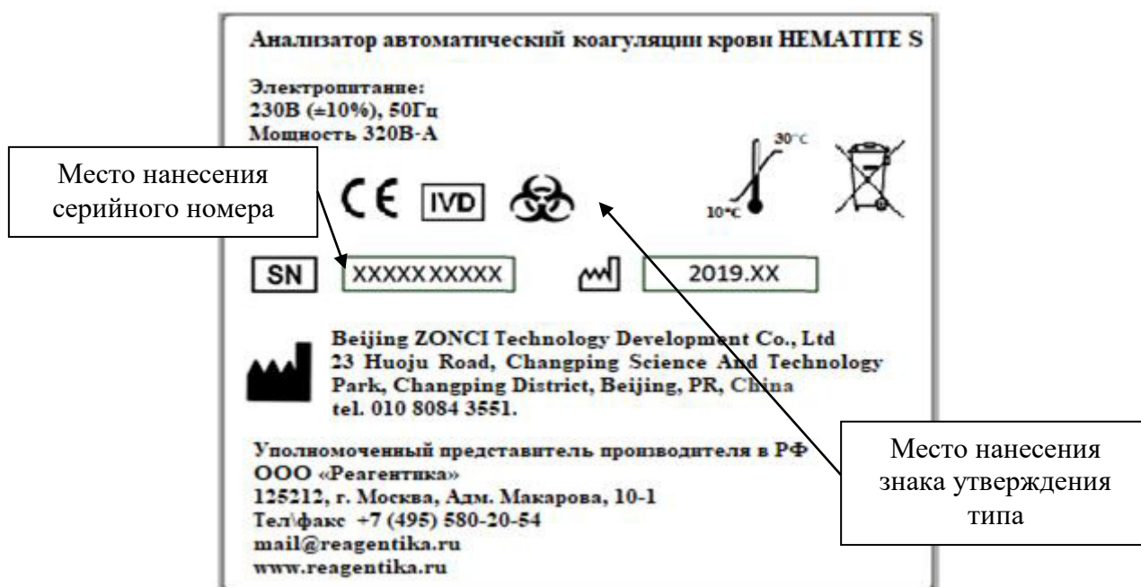
Рисунок 2 – Схема маркировочной наклейки анализаторов с указанием места нанесения знака утверждения типа, места нанесения серийного номера
