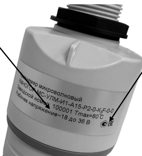
Рисунок 5 – Место нанесения заводского номера и знака утверждения типа на маркировочную табличку уровнемеров микроволновых УМНОГОР
