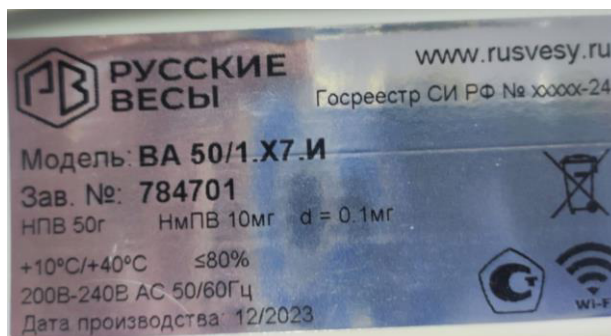
Рисунок 2 – Маркировочная табличка анализаторов влажности ВА
