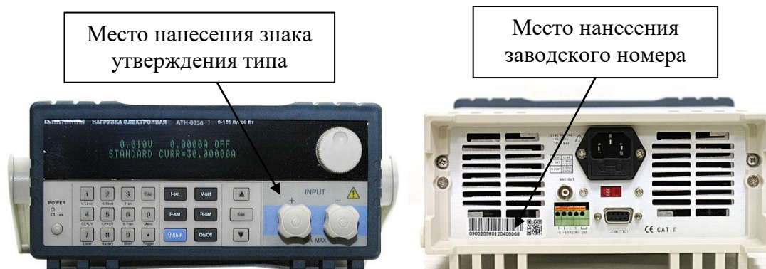
Рисунок 1 – Общий вид нагрузок модификаций АТН-8020, АТН-8030, АТН-8036 с указанием места нанесения знака утверждения типа, места нанесения заводского номера
