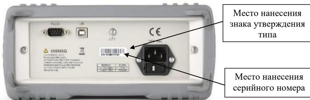
д) задняя панель мультиметров модификаций ТН1952, ТН1942, ТН1941
