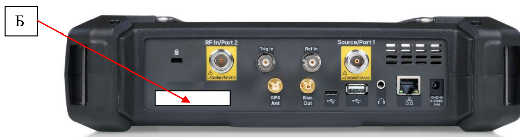
Рисунок 2 – место нанесения серийного номера (Б)
