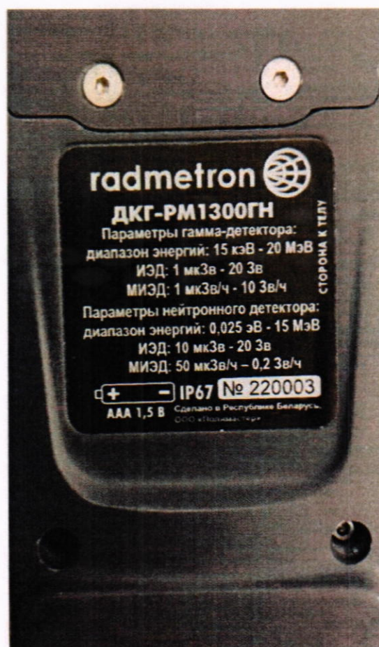
Рисунок 1.3 – Фотографии маркировки дозиметров (изображения носят иллюстративный характер, дата изготовления указывается в паспорте в разделе «Свидетельство о приемке»)
