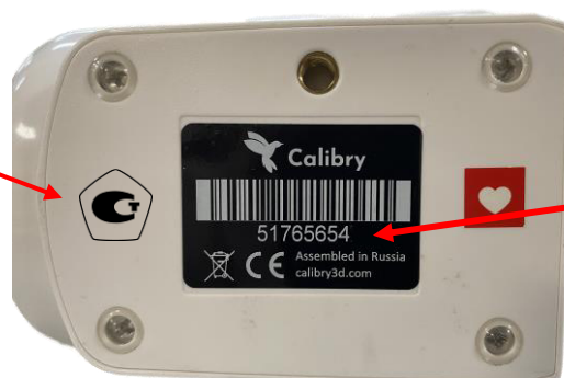
Рисунок 2 - Место расположения маркировочной наклейки с указанием заводского номера прибора и место нанесения знака утверждения типа.
