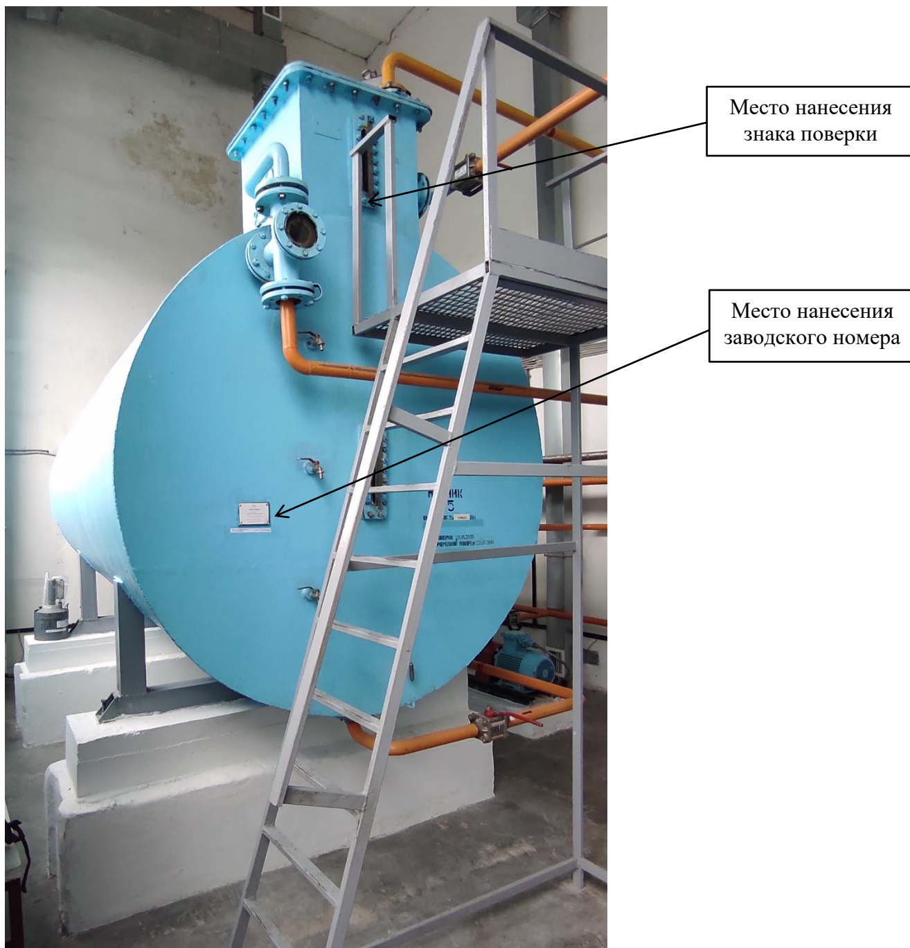
Рисунок 1 – Общий вид мерника технического 1-го класса горизонтального МТГТ-1 № 21 с указанием мест пломбировки и места нанесения заводского номера
