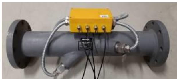
б) – измерительный участок с двухлучевой схемой зондирования потока
