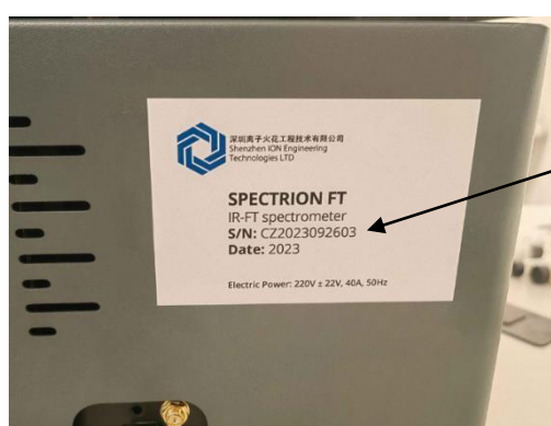
Рисунок 2 – Место нанесения серийного номера на Фурье-спектрометры инфракрасные SPECTRION FT
