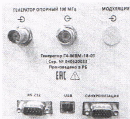
а) Генератор Г4-МВМ-18
