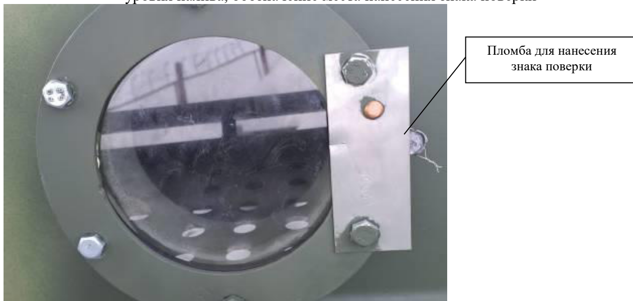
Рисунок 3 – Схема пломбировки от несанкционированного изменения положения указателя уровня налива, обозначение места нанесения знака поверки
