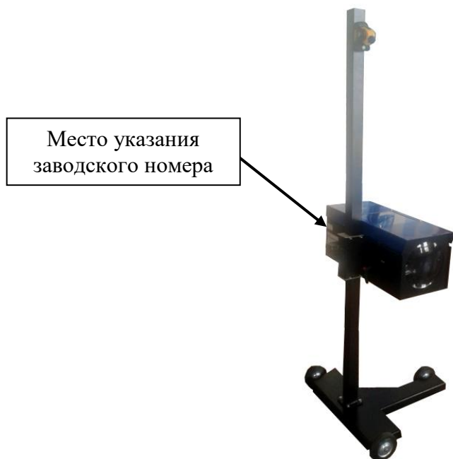
Рисунок 1 – Общий вид приборов для измерений параметров света фар автотранспортных средств ОПК-1 с местом указания заводского номера
