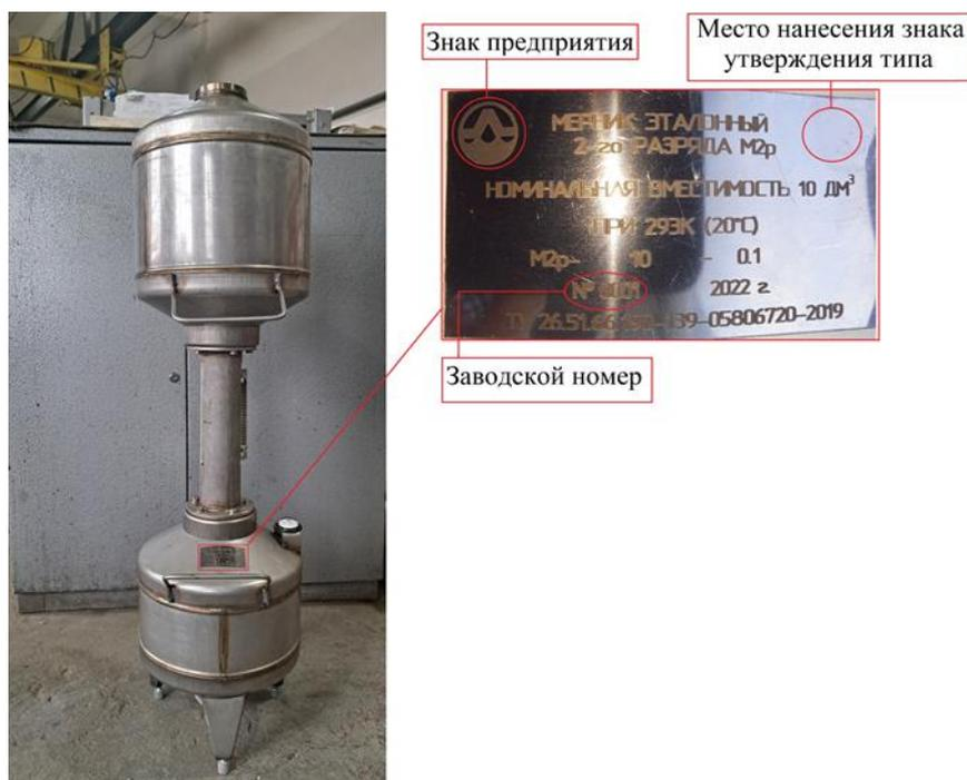
Рисунок 2 – Общий вид средства измерений с указанием мест нанесения заводского номера, знака утверждения типа и знака предприятия.
