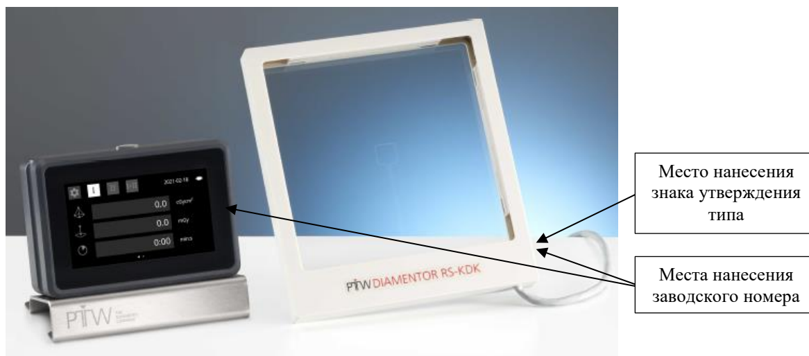
Рисунок 1 - Общий вид дозиметра рентгеновского излучения DIAMENTOR RS-KDK с указанием мест нанесения знака утверждения типа и заводского номера (слева - устройство отображения, справа - ионизационная камера)
