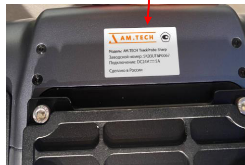
Рисунок 2 – Оптическая система слежения модификации AM.TECH TrackProbe Sharp: а) общий вид; б) место нанесения заводского номера
