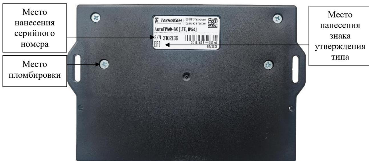
Рисунок 12 – Общий вид контроллеров модификации АвтоГРАФ-GX, исполнения: АвтоГРАФ-GX [IP54], АвтоГРАФ-GX [IP54, АКБ], АвтоГРАФ-GX [LTE, IP54], АвтоГРАФ-GX [LTE, IP54, АКБ], АвтоГРАФ-GX Wi-Fi [IP54], АвтоГРАФ-GX Wi-Fi [IP54, АКБ] (тыльная сторона)
