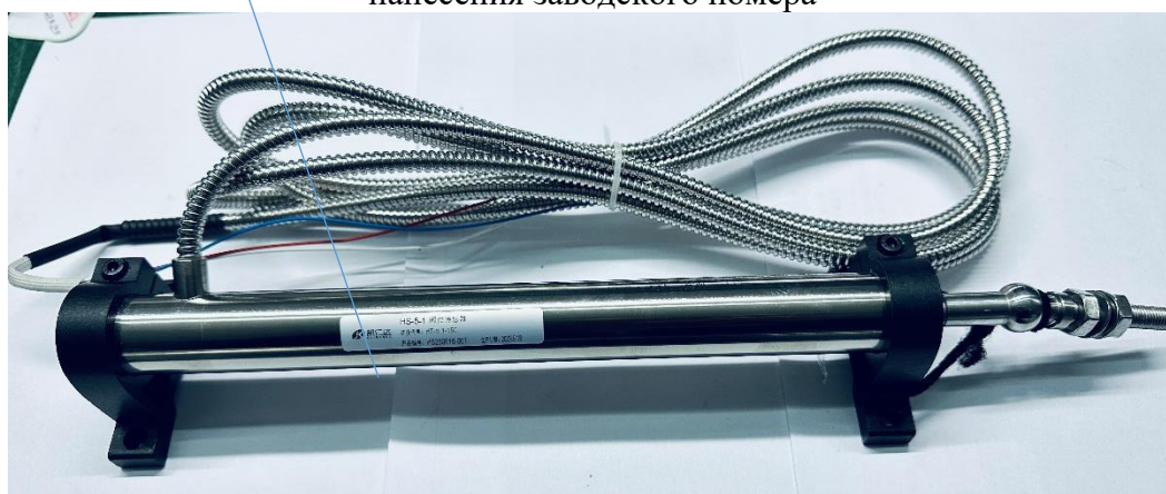
Рисунок 6 – Общий вид датчика положения клапана HS-5-1 из состава установки и места нанесения заводского номера
