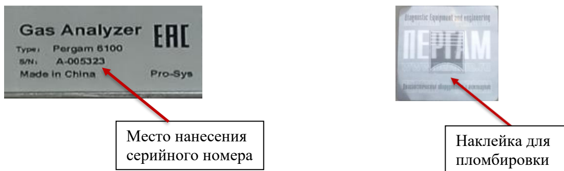
Рисунок 5 – Общий вид идентификационной таблички и наклейки для пломбировки газоанализаторов
