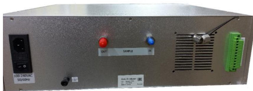
Рисунок 2 – Общий вид газоанализатора PERGAM 6100 (для измерений содержания CO 2 и N 2 O). Задняя панель
