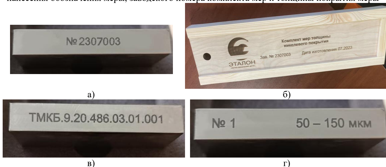
Рисунок 2 – Пример маркировки мер, заводского номера комплекта мер толщины никелевого покрытия
