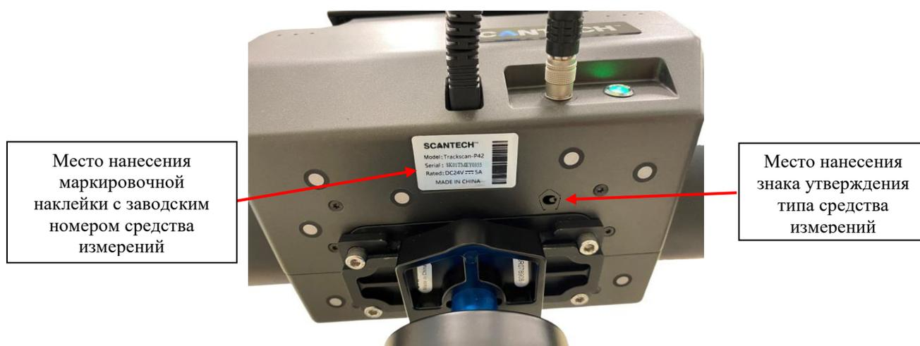
Рисунок 3 - Место расположения маркировочной наклейки с указанием заводского номера системы и место нанесения знака утверждения типа.
