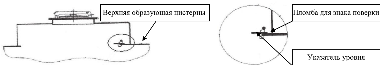
Рисунок 5 – Схема пломбирования указателя уровня налива и место нанесения знака поверки
