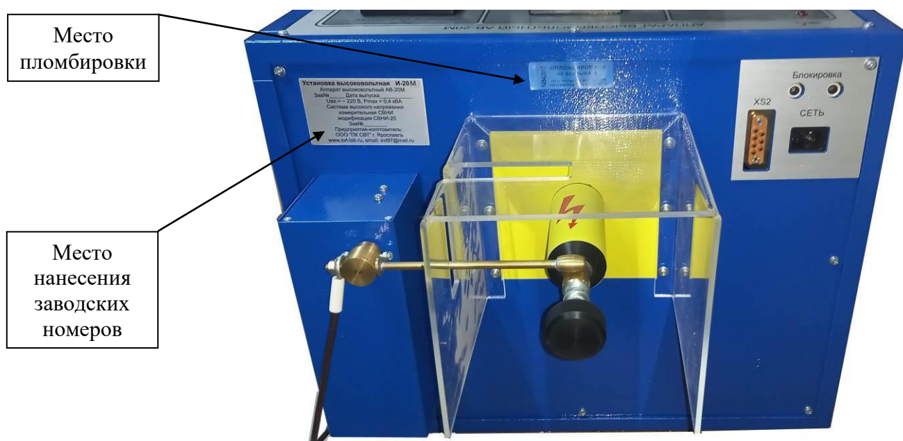
Рисунок 2 – Общий вид систем модификации СВНИ-20 в составе аппарата высоковольтного АВ-20М. Вид сзади
