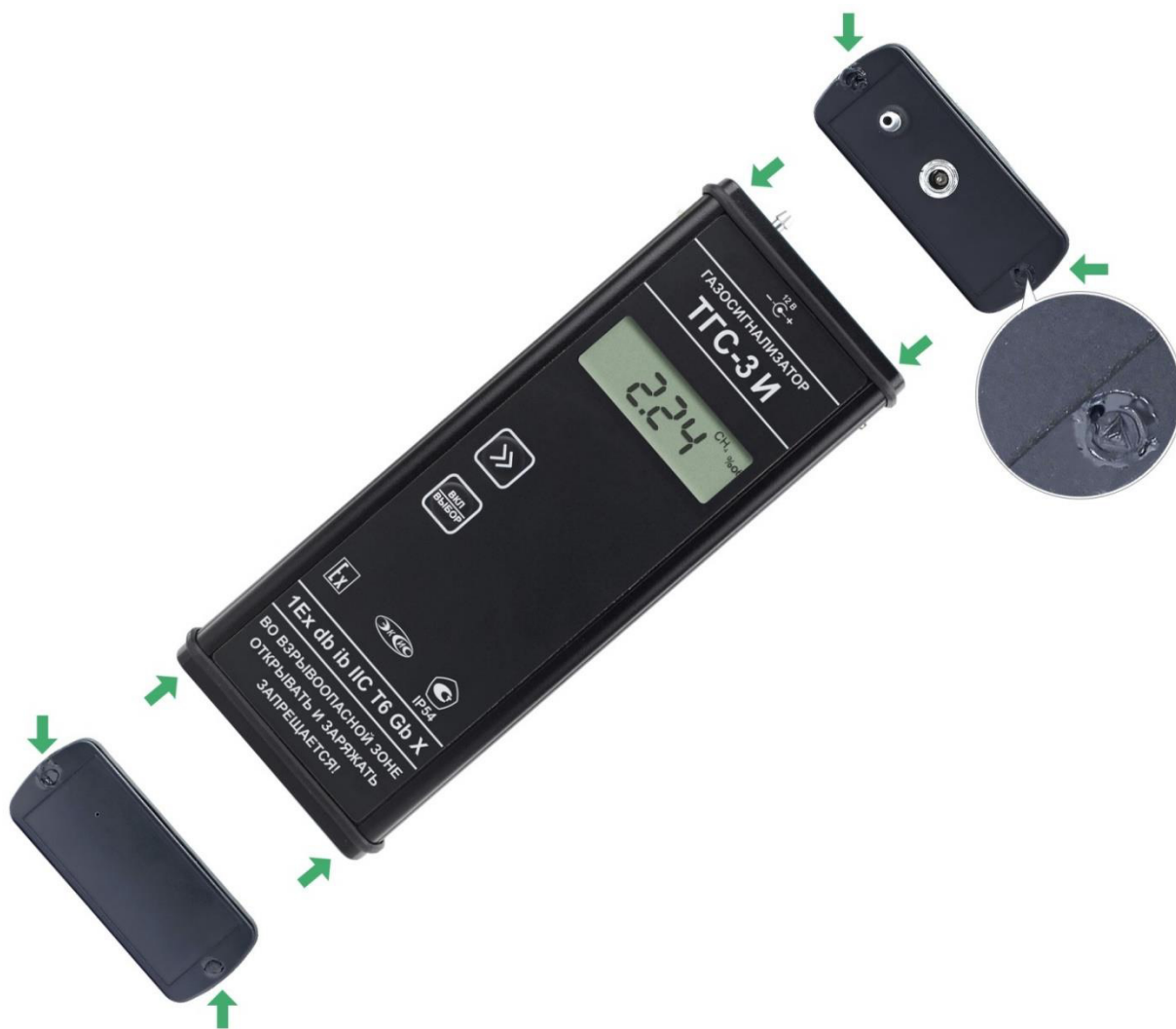
Рисунок 2 – Схема пломбирования корпуса газосигнализатора ТГС-3 И методом нанесения печати в углубления крепежных винтов на корпусе (места пломбирования указаны стрелками)
