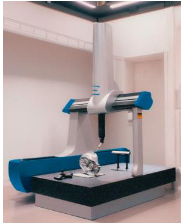
б) КИМ в синем цветовом исполнении с регулируемой рамой в основании
