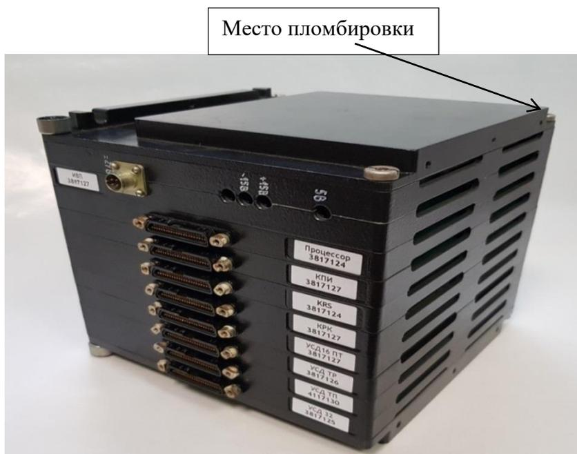
ж) Общий вид узлов установленных в модуль
