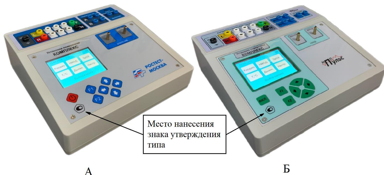
Рисунок 1 – Общий вид установок с указанием мест нанесения знака утверждения типа
