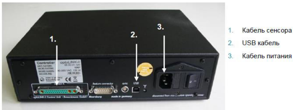
б) Контроллер OptoLink
