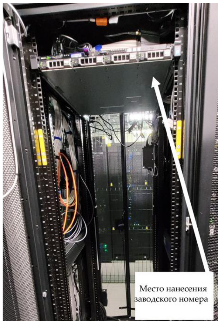
Рисунок 1 - Общий вид сервера ИВК с указанием места нанесения заводского номера.
