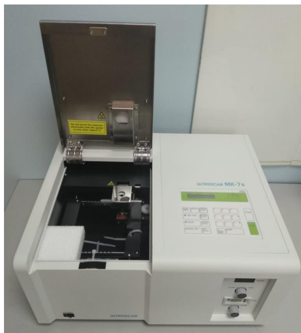
Рисунок 1 – Общий вид анализатора хроматографического IATROSCAN MK-7s
