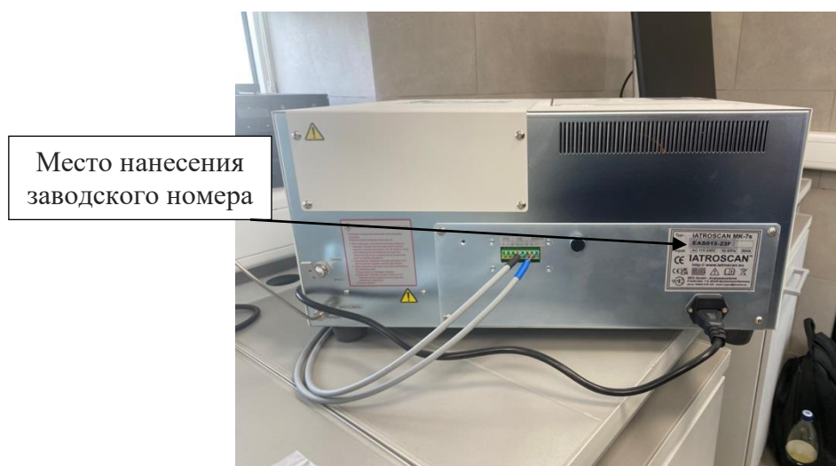
Рисунок 2 – Место нанесения заводского номера на анализатор хроматографический IATROSCAN MK-7s
