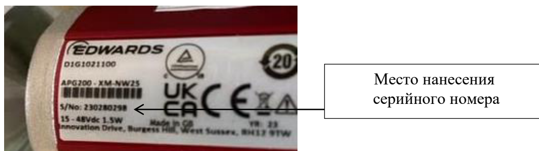
Рисунок 5 – Место нанесения серийного номера вакуумметра на датчик
