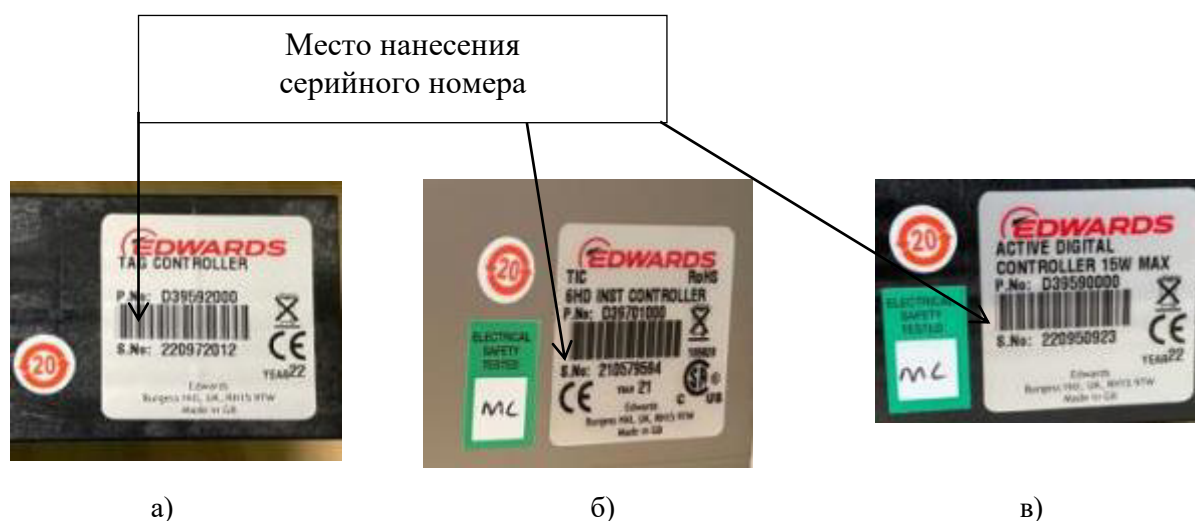
Рисунок 6 – Место нанесения серийного номера на контроллер а) TAG; б) TIC; в) ADC
