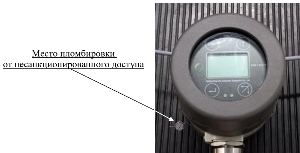
Рисунок 2 - Схема пломбировки от несанкционированного доступа
