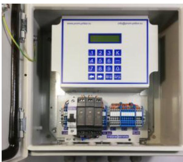
а) блок процессора в металлическом корпусе
