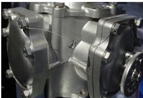
Рисунок 4 - Пломбировка измерителя объема по периметру верхней и боковой крышек и его регулировочного винта (при наличии)
