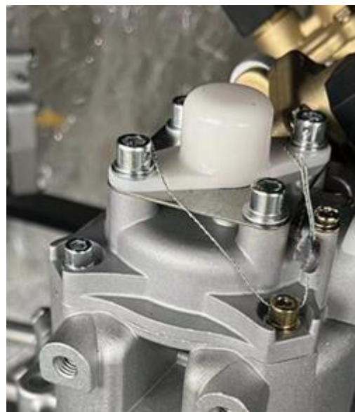
Рисунок 5 – Пломбировка генератора импульсов
