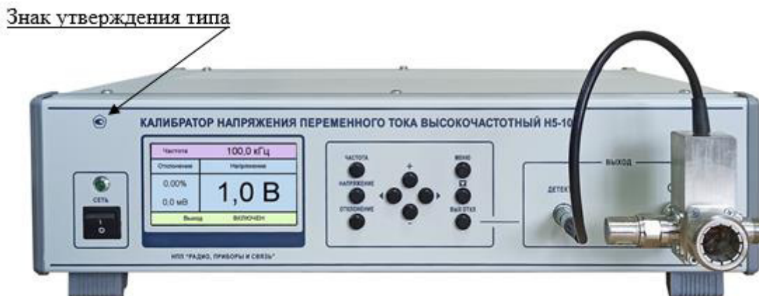
Рисунок 1 – Общий вид калибратора напряжения переменного тока Н5-10 и место нанесения знака утверждения типа
