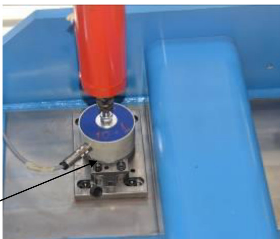
Рисунок 3 – Место установки пломбы на силоизмерительных датчиках измерительных тяг F_x , F_z , M_y (по одному датчику на каждой тяге)
