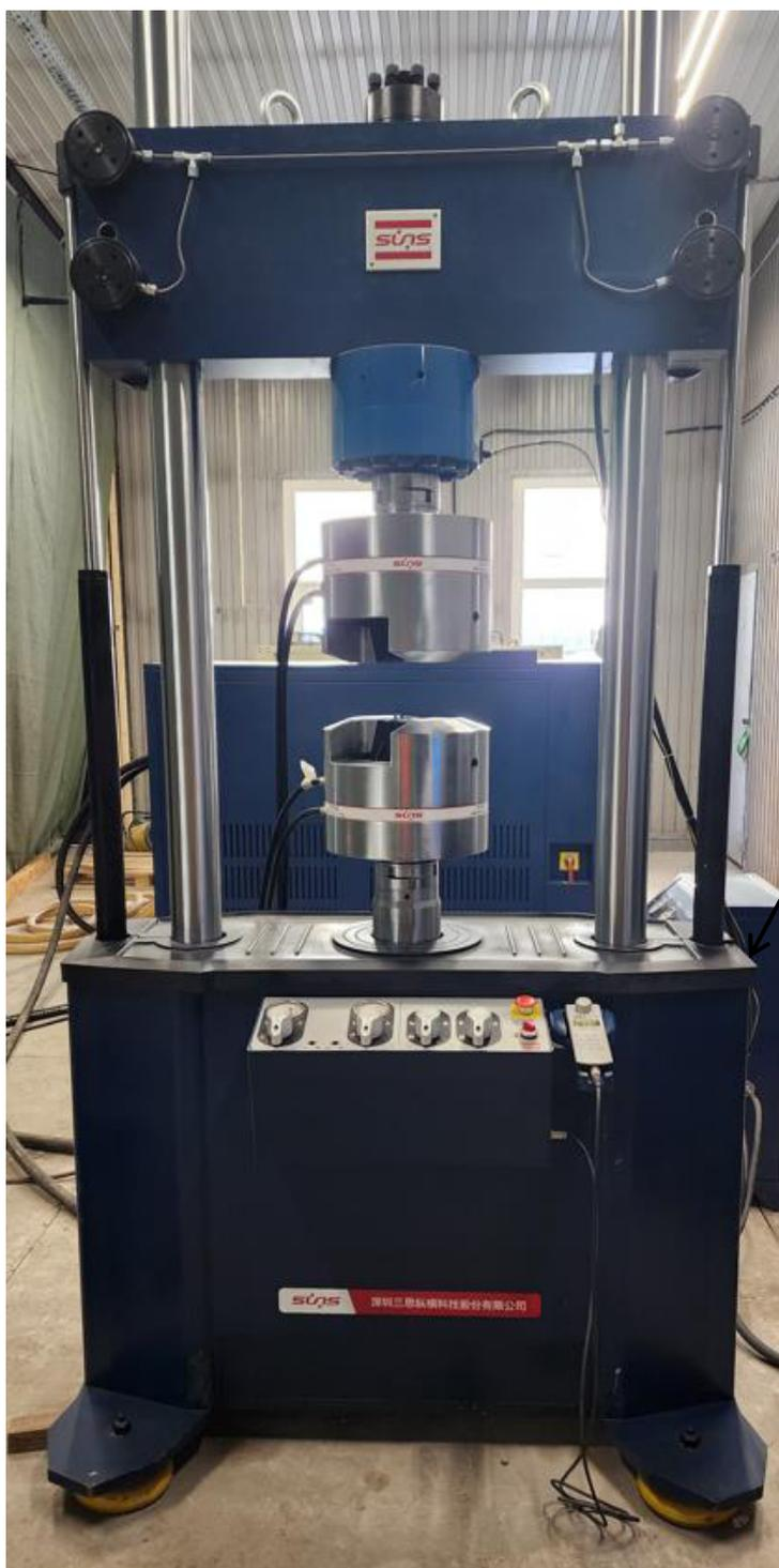
Рисунок 1 - Общий вид машины сервогидравлической испытательной SUNS890-500
