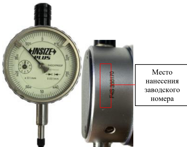
Рисунок 16 – Общий вид отсчетного устройства модификации 2890-1F с указанием места нанесения заводского номера
